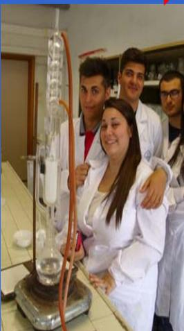
estrazione con alcool etilico di "essenze" odorose da fiori essiccati di lavanda mediante estrattore Soxhlet per ottenimento di Profumatori ambiente
